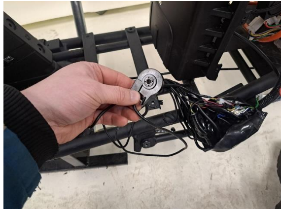
Pujota jalkatuen sähkölukon johto pois johtosarjasta.
