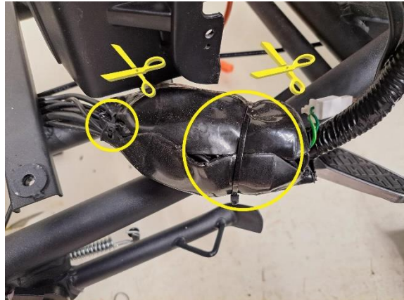
Katko johtosarjan liittimien suoja kiinni pitävät nippusiteet (sivuleikkurit).
